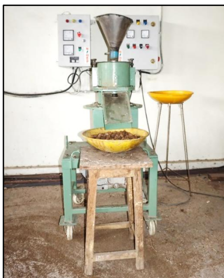
Fig. 1. Flat die type pelleting machine
